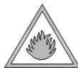
RIESGO DE INCENDIO
