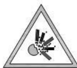
RIESGO DE EXPLOSION
