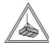
RIESGO CARGAS SUSPENDIDAS
