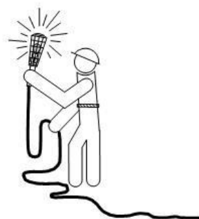
PORTALAMPARAS CON MANGO DE MATERIAL AISLANTE
