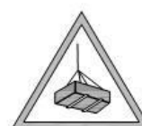
RIESGO CARGAS SUSPENDIDAS
