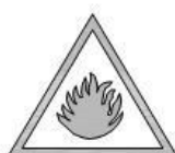
RIESGO DE INCENDIO
